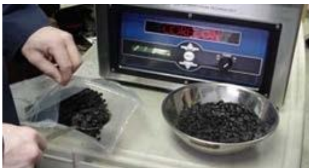
Figura 803 - 1. Colocación de la muestra en la bolsa interna
